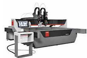
Bystronic Wasserstrahlanlage ByJet Flex Leistung: 3.600 bar Arbeitsbereich: 4.000 x 3.000 mm
