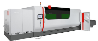
Bystronic Laseranlage ByStar Fiber 4020 Leistung: 10,0 kW Arbeitsbereich: 4.000 x 2.000 mm
